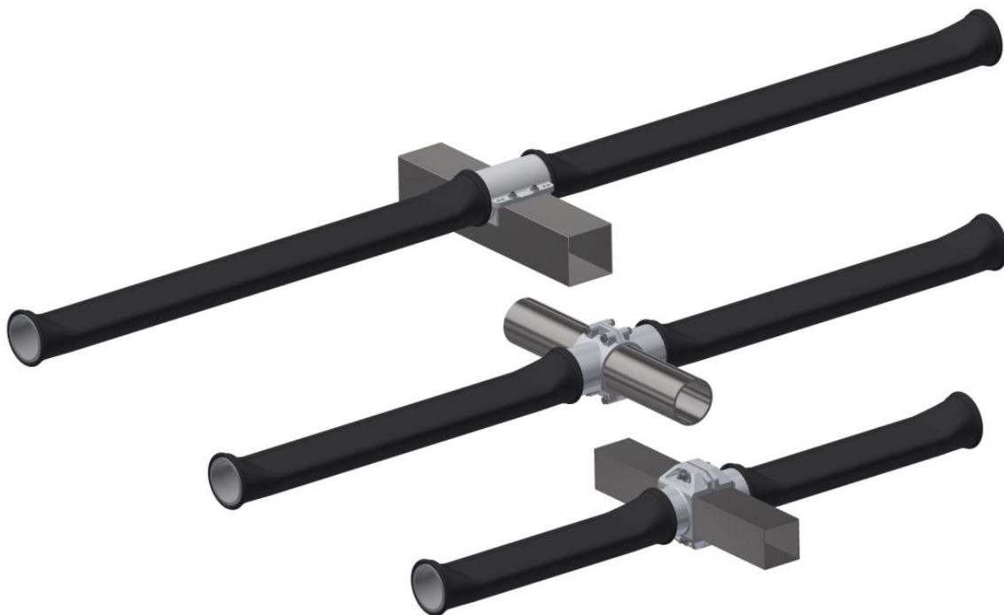
OXYFLEX® - OM Oval-Membran-Rohrbelüfter haben einen kräftigen und solide gefertigten Korpus aus Polypropylen (PP), auf dem die Membranen mit je zwei Edelstahlschellen fixiert werden. Der Korpus besitzt mittig eine über die gesamte Begasungslänge reichende breite Sicke, die zu einer deutlichen Steigerung der Effizienz und Verlängerung der Nutzungsdauer im Vergleich zum Standardrohrbelüfter führt.
